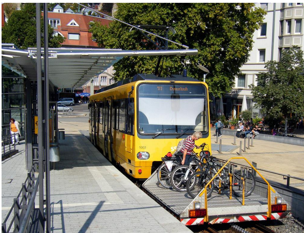
Joonis 21. Trammile lisatud rataste transportimise platvorm. Allikas: DYATICA 17
